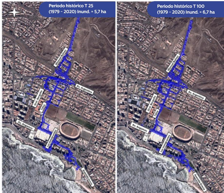
**Figura 7.1** Áreas de inundación de la quebrada El Toro, para T=25 y T=100 años
